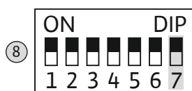
Fig. 16: Микропереключатель 1: внутренний зуммер
