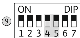
Fig. 18: Микропереключатель 2: индикация интервалов сервисного обслуживания
