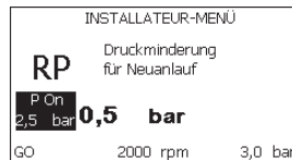
Abbildung 18: Einstellung des Neustartdrucks
