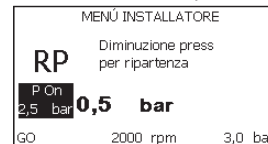
Figura 18: Impostazione della pressione di ripartenza
