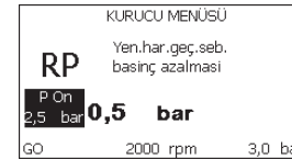
Şekil 18: Yeniden başlatma basıncının ayarlanması
