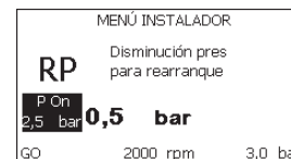
Figura 18: Configuración de la presión de reencendido
