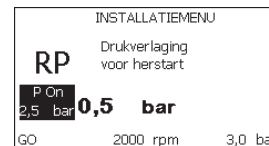
Afb. 18: Instelling van de herstartdruk
